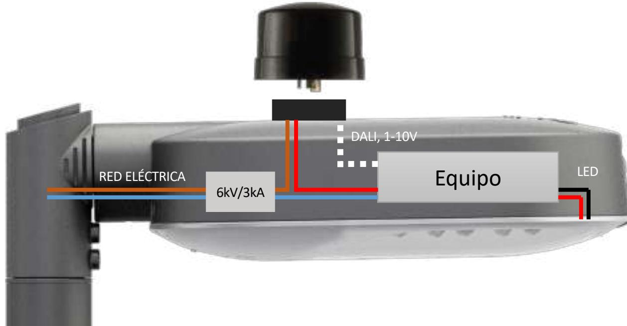
Los nodos o fotocélulas se conectan a la red eléctrica (nos obliga a poner un protector contra sobretensiones y aun así quedan expuestos a sobretensiones permanentes de red)
